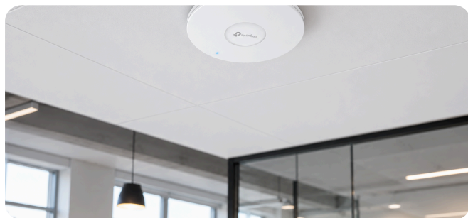
Un punto de acceso ubicado según el plano del local cubre mejor que un router potente puesto donde entra el cable.
