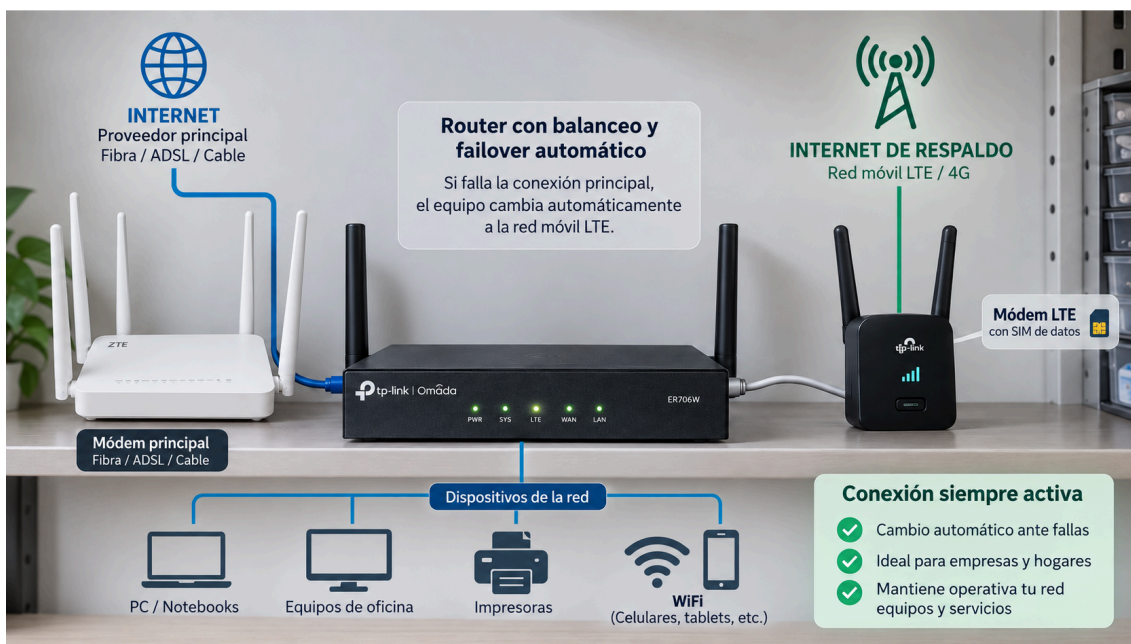
Esquema de una red con conexión de respaldo: el equipo detecta la caída del enlace principal y conmuta automáticamente a la red móvil.
